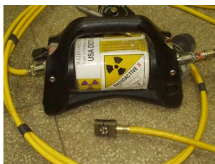
Figura 3.4 - Foto do irradiador modelo 880 Sigma - Sentinel
